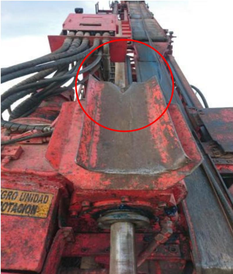
Permite que la tubería sea guiada y no impacte con otras estructuras.
